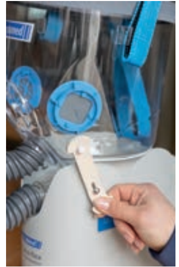
Abb. 4 Maske mit Gummilaschen befestigen und Verbindungsschlauch aufstecken.
